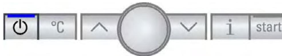
Mit der **stand by** Taste wird das Gerät eingeschaltet und in Betrieb genommen oder aus der Bezugsbereitschaft in Stand-by gesetzt.
