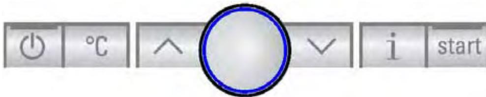
Mit dem Drehknopf kann im Display durch Drehen nach links und rechts navigiert werden, oder es können im Menü Parameter verstellt werden.
