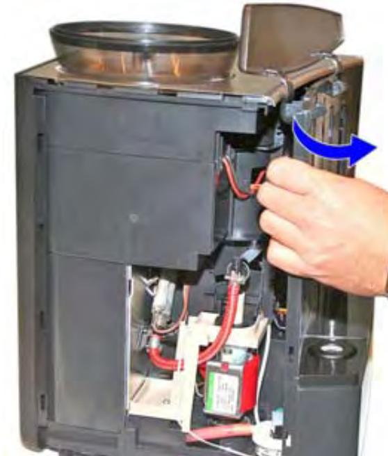
4. Zum Abnehmen des linken Gehäuse-Seitenteils die Trägerplatte der Wassertank-Kupplung nach oben aus dem Gehäuse-Seitenteil drücken.
