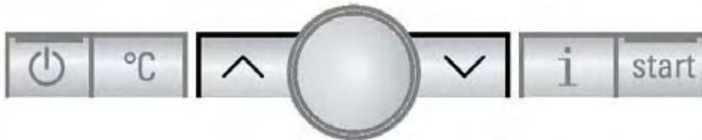
Mit den Pfeiltasten **A** und **V** kann in den Menüebenen (Navigationszeile) nach oben und unten navigiert werden.
