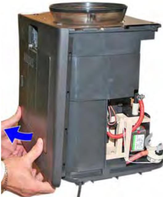
3. Gehäuse-Seitenteil nur leicht nach außen ziehen und die Verrastungen im unteren Gehäuse-Bereich lösen.
