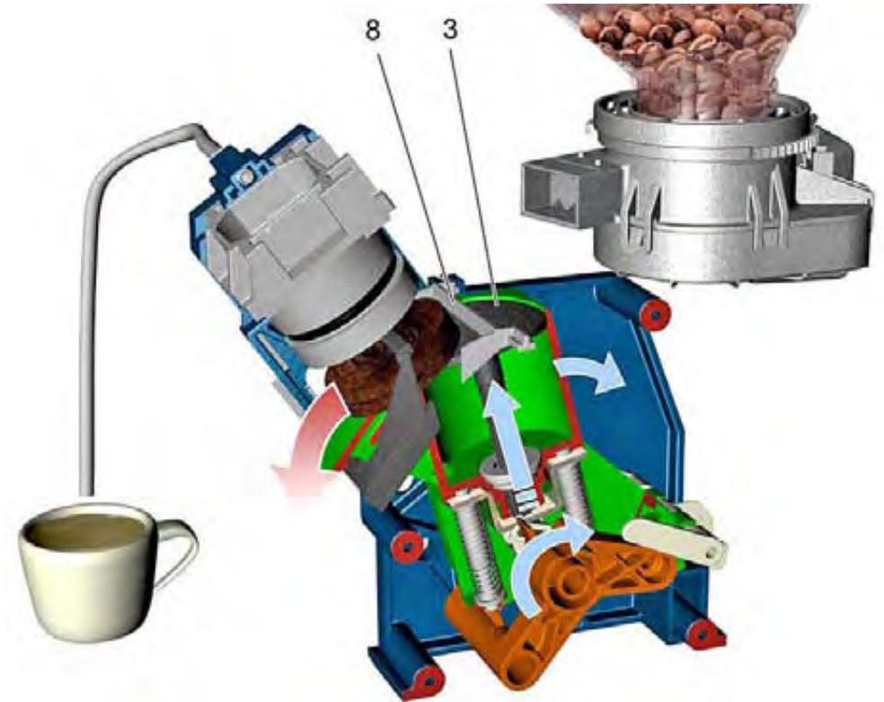
Ist die programmierte Wassermenge erreicht, stoppt die Pumpe. Der Druck in der Brühkammer sinkt und der Kaffeesatz wird zu einem festen Kuchen verdichtet. Die Brühkammer wird zurück in die Ausgangsposition bewegt. Dabei wird der Pressstempel (3) zusammen mit dem Kaffeesatz nach oben gedrückt. Druck und Restwasser entweichen durch Öffnungen im Kolben des Pressstempels in die Abtropfschale. Beim Hinunterfahren der Brühgruppe wird der Kaffeesatz durch den Abstreifer (8) in den Satzbehälter geleert.
