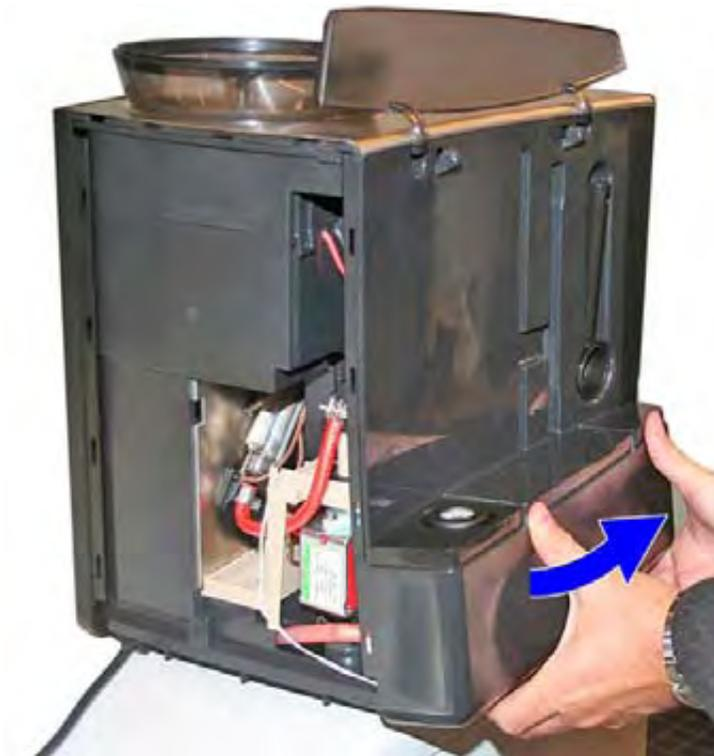
3. Von der Geräte-Rückseite her linkes Gehäuse-Seitenteil in Pfeilrichtung ziehen und alle Verrastungen lösen.
