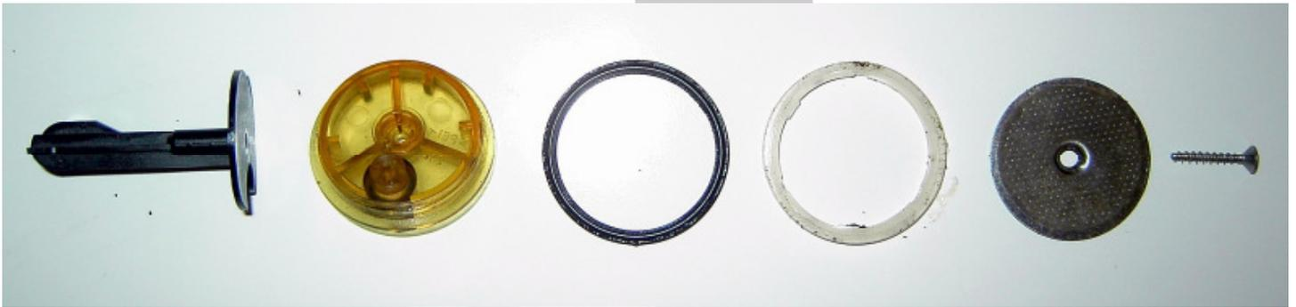
Die Lage des Cremaventils können Sie auf den Fotos erkennen. Hier ist in aller Regel besonders viel Reinigungsaufwand gefragt! Bei manchen Varianten kann es sein, das auf dem zylindrischen Teil mit den drei Stegen ein O-Ring verbaut ist. Diese muss in aller Regel auch nicht gewechselt werden.
