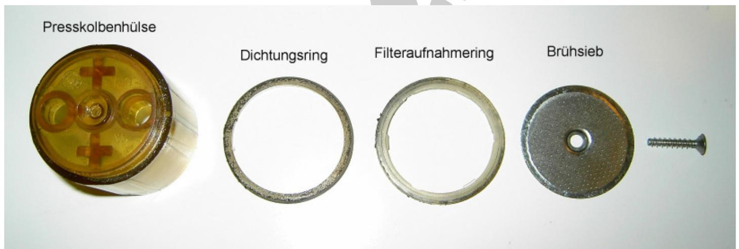
Hier alles gründlich reinigen, besonders das Brühsieb! Den Dichtungsring können Sie jetzt ggf. austauschen. An dieser Stelle wird die gelbe Konturdichtung, oder je nach Set der große O-Ring, verbaut.
