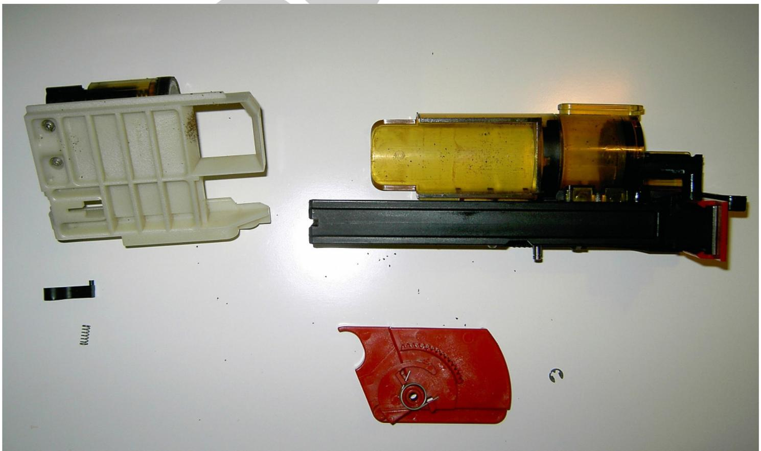
Jetzt sollten Sie noch den Bolzen des Schließteils entnehmen. Dazu zuerst die gelbe Hülse etwas zurückziehen (1.) und den Bolzen aus dem Mittelteil entnehmen (2.).
